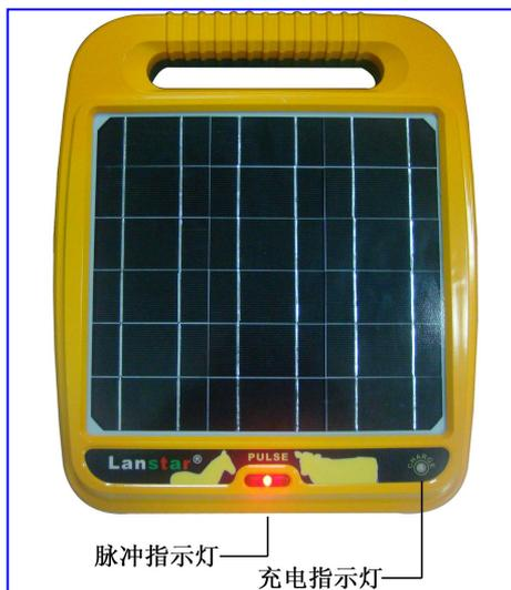
a) 中间LED灯（红色）表示高压脉冲指示，输出脉冲电压时，指示灯亮，无脉冲电压输出时灭，控制器正常运行时，一闪一灭，周期1.5s，随着电池的消耗，周期会逐步变长，直到电池耗尽，灯就熄灭。
